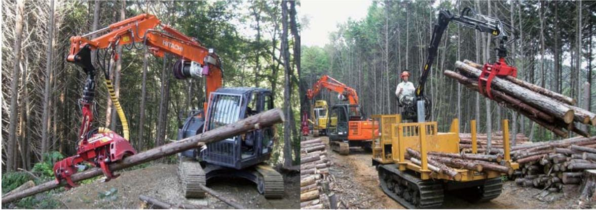
林業機械による造材作業
